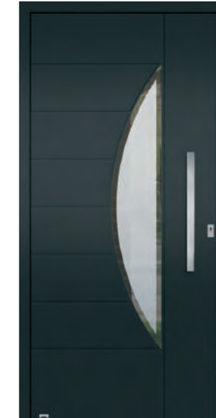
5324 Hier flügelüberdeckend mit Stoßgriff 5803.600 dargestellt. V: VSG mattiert mit klarem Rand O: ca. RAL 7016 Nightgrey FS U p : 1,0
